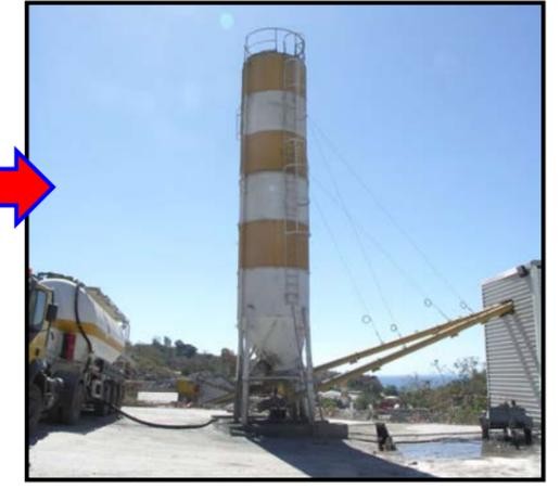
Remplissage des silos de ciment
