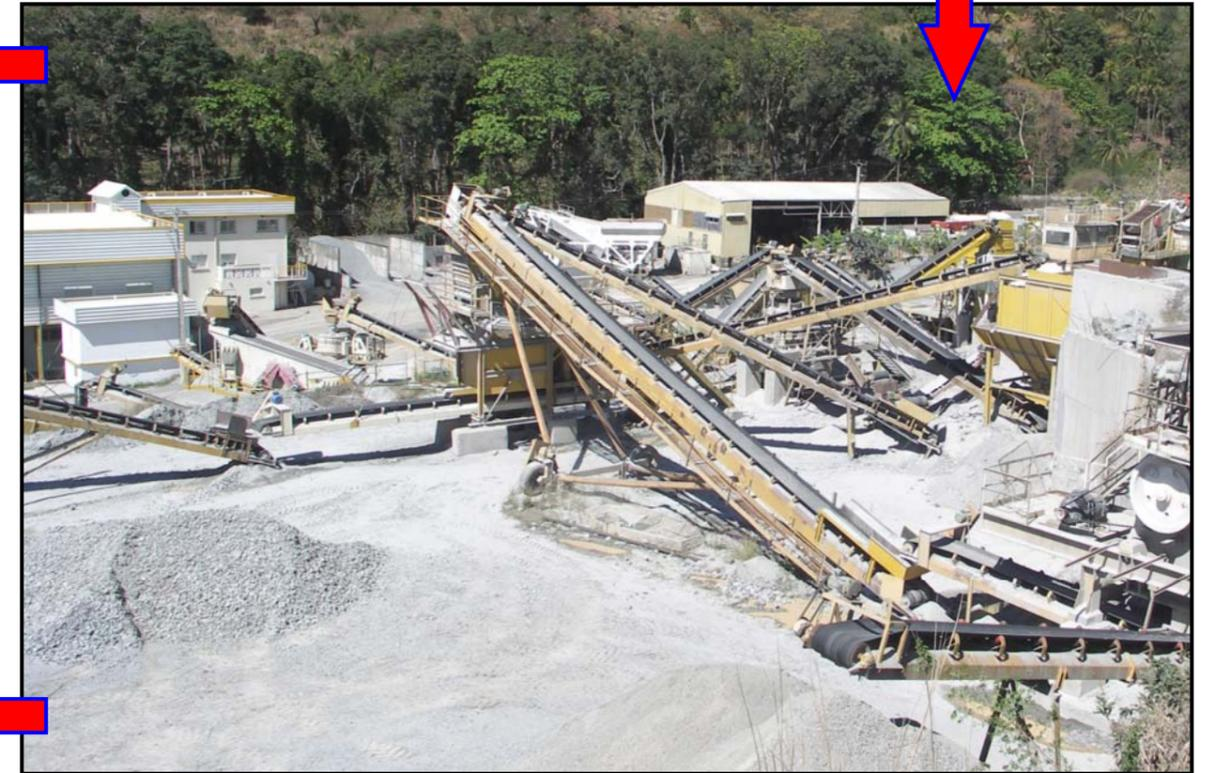
Passage dans broyeurs et cribles de classement
